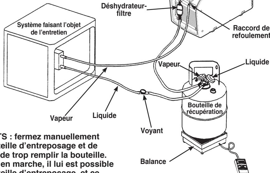
**AVERTISSEMENTS :** fermez manuellement les robinets de la bouteille d'entreposage et de l'appareil afin d'éviter de trop remplir la bouteille. Lorsque le siphon est en marche, il lui est possible de trop remplir la bouteille d'entreposage, et ce, même si la bouteille est dotée d'un capteur de hauteur de flotteur. Le siphon peut fonctionner même si l'appareil est désactivé.
