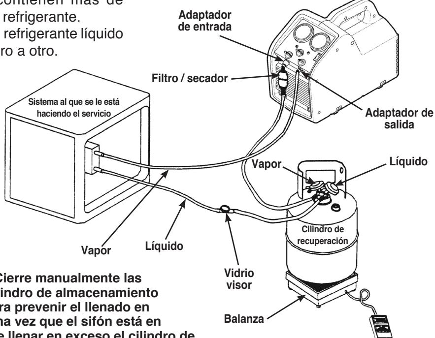
**ADVERTENCIA:** Cierre manualmente las válvulas tanto en el cilindro de almacenamiento como en la unidad, para prevenir el llenado en exceso del cilindro. Una vez que el sifón está en funcionamiento, puede llenar en exceso el cilindro de almacenamiento, incluso si el cilindro está equipado con un sensor de nivel de flotador. El sifón puede continuar incluso cuando la unidad está apagada.
