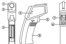
Richten Sie das Gerät auf den Messpunkt und MEAS - Taste drücken, und die gemessene Oberflächentemperaturwert erscheint im LCD – Display. Beachten Sie die Zielentfernung und das Messfeld.
