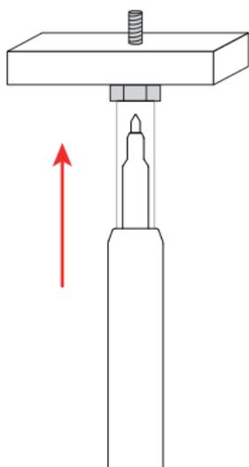
Per eseguire un test, collocate la punta sull'oggetto da testare e premete per fare scorrere la protezione.
