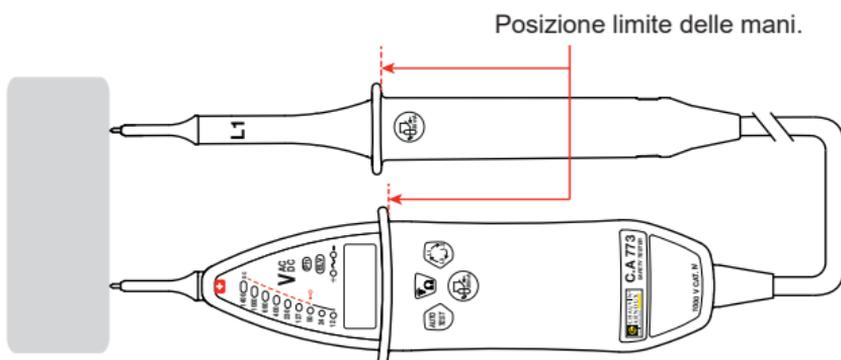
Collocate le punte di contatto sull'elemento da verificare e mantenete saldamente il contatto.
