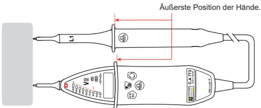
Halten Sie die Prüfspitzen fest an den Prüfling.
