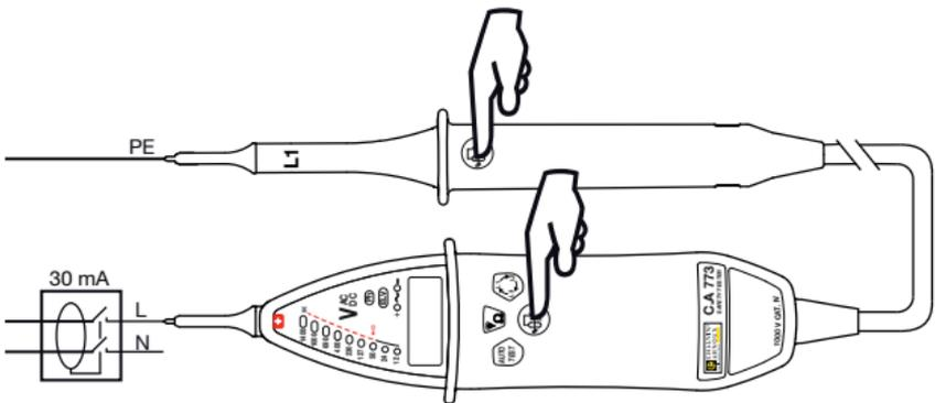
Bei einer Spannung zwischen  $8$  und  $400\text{ VRMS}$ . wird der Test ausgelöst.
