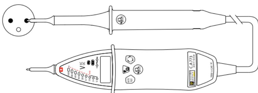
Si la punta de prueba se encuentra en la fase, el indicador **Ph** (fase) parpadea y el instrumento emite pitidos.
