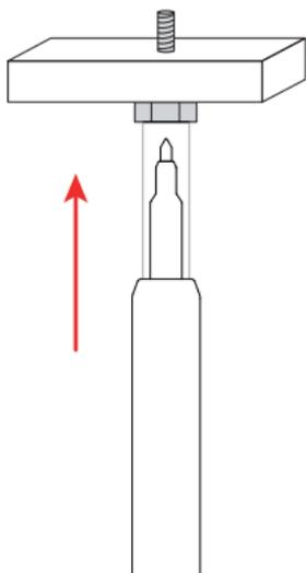
Vorgehensweise beim Prüfen: Halten Sie die Spitze an den Prüfling und drücken Sie, bis die Schutzvorkehrung zurückschiebt.
