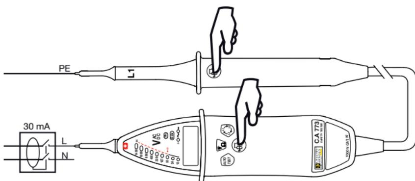
Si la tension mesurée est comprise entre 8 Veff et 400 Veff, le test est déclenché.
